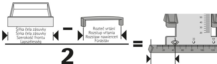
Vzdáenosť od bočnej hrany čela zásuvky po první montážní otvor úchytky (min. 10 mm / max. 334 mm)
