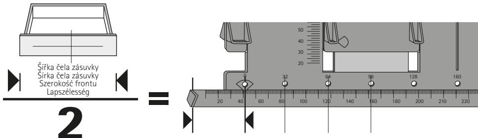
Vzdáenosť od bočnej hrany čela zásuvky po montážní otvor knoflíkové úchytky (min. 10 mm / max. 334 mm)
